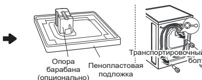
Снимите транспортировочные болты и опоры.
