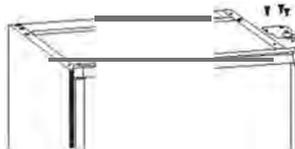
5. Снимите нижние регулируемые ножки. И отвинтите нижнюю петлю
