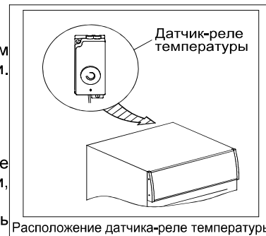
Расположение датчика-реле температуры
